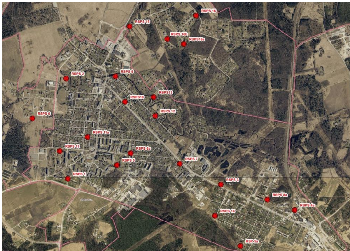
Joonis 3 Rapla linna reoveepumplate asendiplaan
